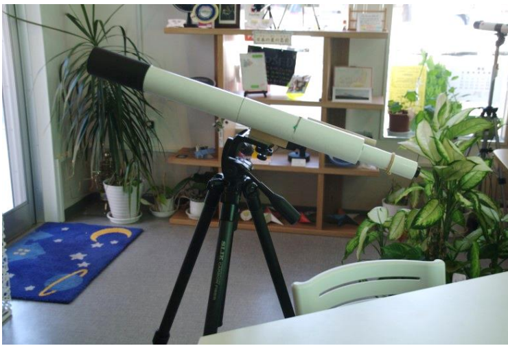
対物レンズ口径:5cm・対物レンズ焦点距離:600mm 倍率:50倍(付属アイピース利用の場合)
