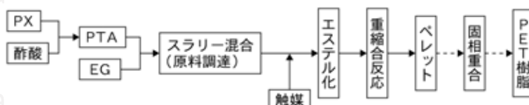
図2-1 PET樹脂の製造プロセス
