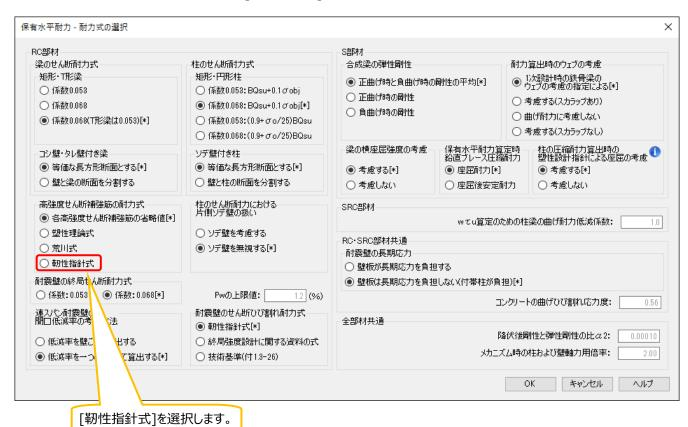
テキスト入力の場合は、保有水平耐力計算データの [ULA4] (部材特性の計算条件)の9項目で、以下の下線部のように入力します。
