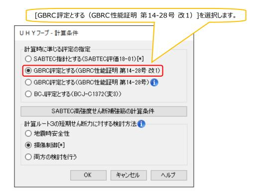
テキスト入力の場合は、許容応力度計算データの [HSUH] (UHYフープの計算条件)の1項目で、以下の下線部のように入力します。
