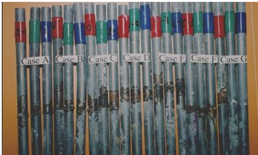
図－3.1.3.12 海洋大気中に 25 年間暴露された打継ぎ目部を有する供試体中の鉄筋の腐食状況[30]
