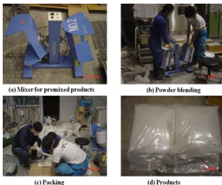
図－3.2.2.9 自己治癒セメント組成物の製造[9]
